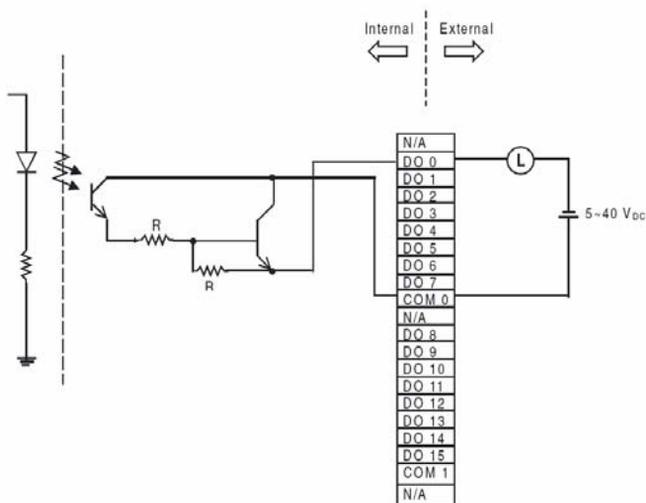
Figure 46: ADAM-5056SO module wiring diagram
