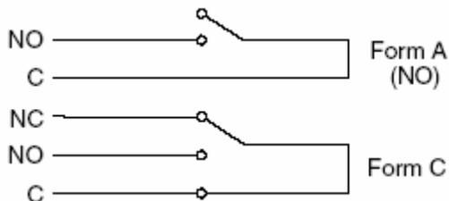
Figure 48: Relay output
