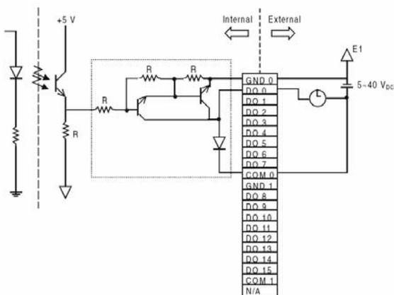
Figure 44: ADAM-5056S module wiring diagram
