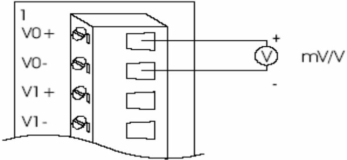
*Figure 11: Millivolt and volt input*
